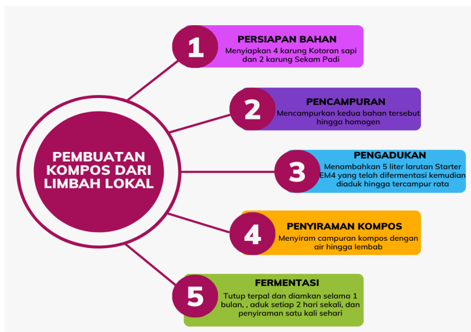
Gambar 3. Skema Pembuatan Pupuk Kompos
